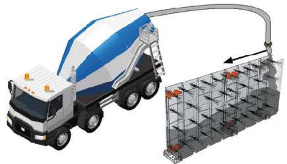
Coulage en une seule passe, on laisse fuir le béton et on avance. On tapote avec un maillet sur les zones dites creuses au niveau du projecteur(s) et skimmer(s) pour un bon remplissage.
