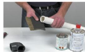
Bien dépolir avec du papier de verre le tuyau et le raccord, puis nettoyer les deux parties avec le décapant.
