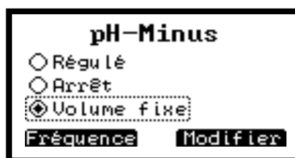
Figure 46. réglage du volume et de la fréquence d'injection
