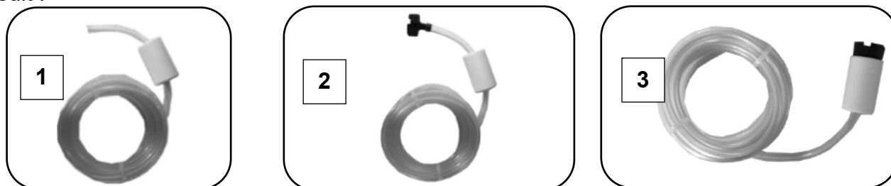
Figure 20. montage de la crépine d'aspiration
