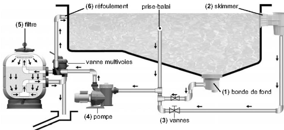
L'eau est aspirée du fond de la piscine par la bonde de fond (1) et à la surface par les skimmers (2) et arrivé au filtre (5) par des conduits séparés équipés chacun de vannes (3). L'eau filtrée est ensuite refoulée à la piscine par les bouches (6). Ces bouches de refoulement sont installées du côté opposé des skimmers et de la bonde de fond renouvelant ainsi toute l'eau de la piscine.
