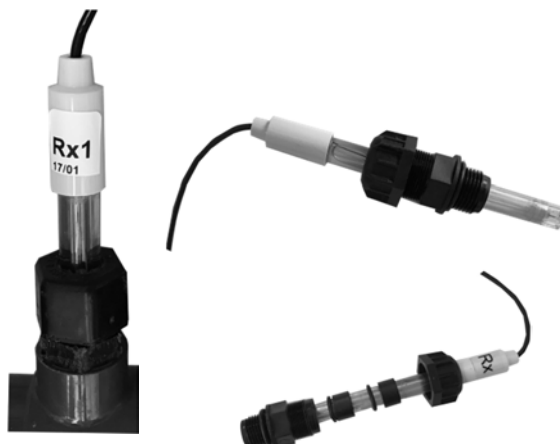
Figure 17. montage des portes-sondes et du capteur température d'eau
